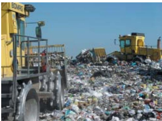
Fig.37 - Operazione di compattazione dei rifiuti in discarica
