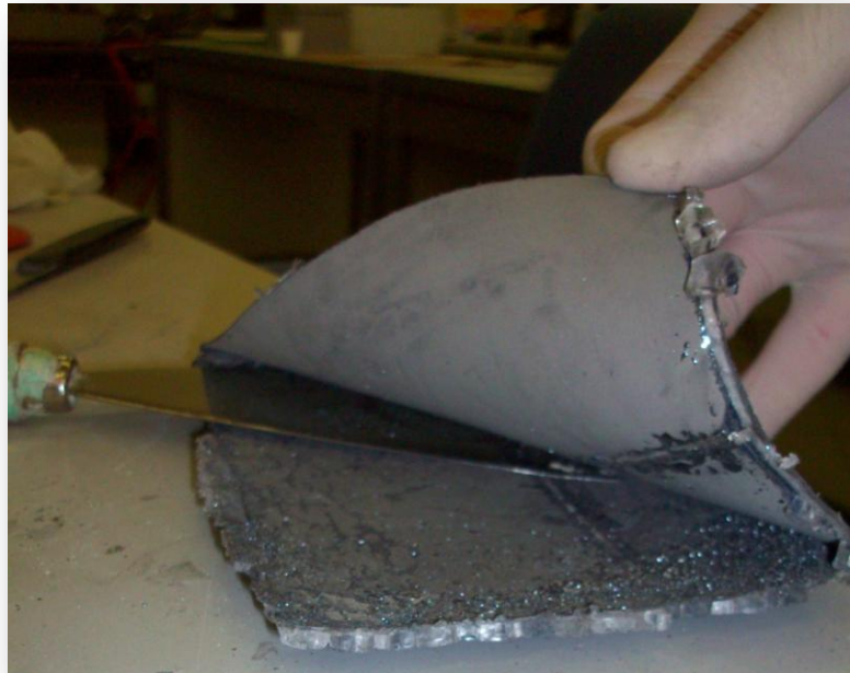
Figura 5.3: Prodotti del bagno criogeno seguito dalla separazione manuale degli strati
