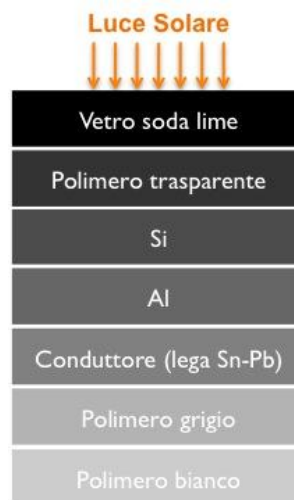
Figura 6.10: Complesso del pannello policristallino
