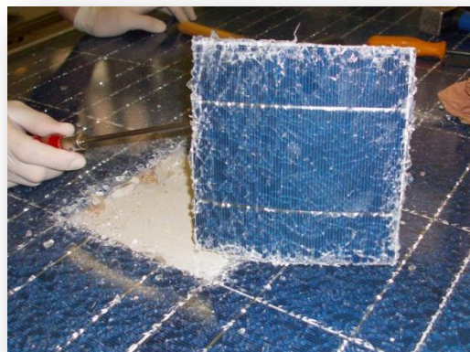
Figura 5.1 : Taglio di una cella fotovoltaica policristallina
