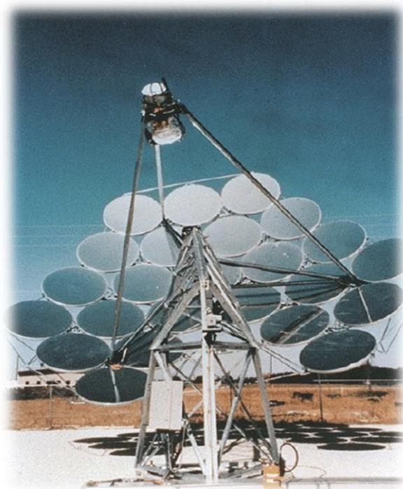
Figura 92 - CPG-460 Multifaceted Concentrator, modello concepito per sistemi Stirling da 7.5kWe [RSE, 2001]
