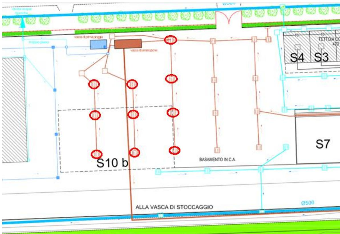
Figura 165 - Planimetria piazzole di stoccaggio (tratteggio blu) e di triturazione (adiacente subito sopra) con in evidenza il sistema di captazione delle acque. [S.A.BA.R. 2010]
