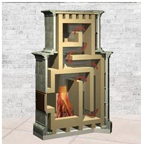
Figura 71 - Le stufe ad accumulazione (vista interna) [Artistica Marmi, 2014]
