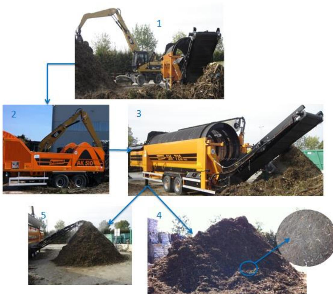
**Figura 118 - Operazione di R03 in S.A.BA.R: selezione con ragno(1), triturazione (2) con trituratore a cui è collegato in serie il vagliatore (3) da cui in uscita si distingue: il sopravaglio a destra (4) ed il sottovaglio a sinistra (5) [S.A.BA.R, 2015]**
