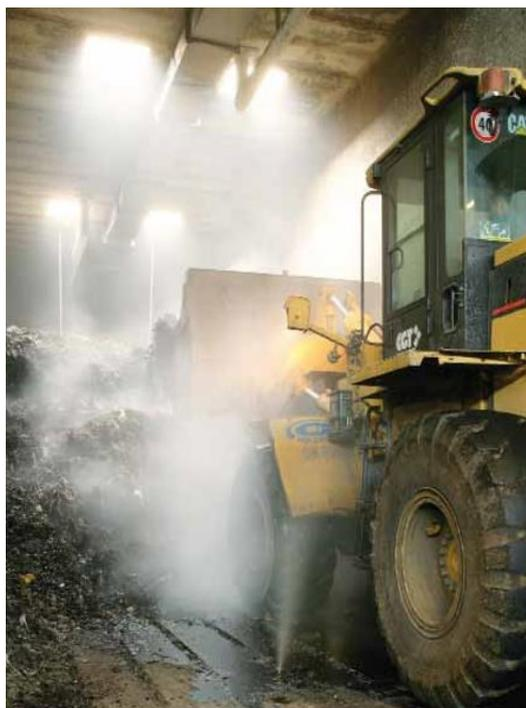
**Figura 170 - Pala che inserisce la miscela cella di bioessiccazione**
