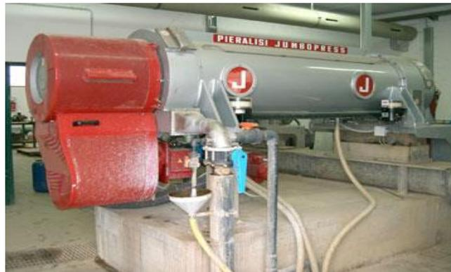
*Figura 27-Foto di una centrifuga*
