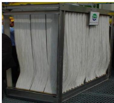
*Figura 52-Rappresentazione di una membrana a fibra cava*
