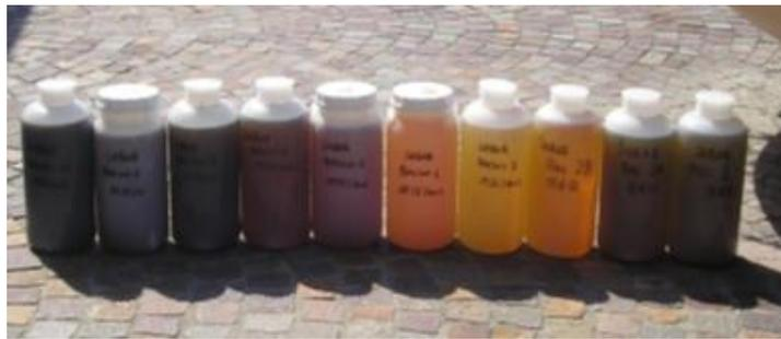
*Figura 21- Esempi di campioni di percolato con caratteristiche diverse*
