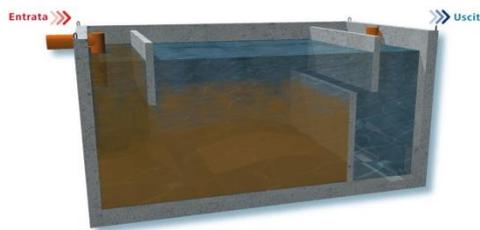
**Figura 9-Modello di un dissabbiatore**
