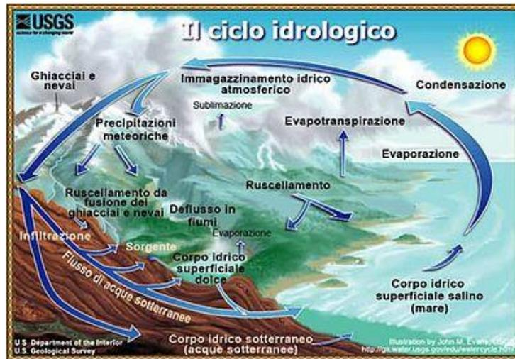
*Figura 3-Schema del ciclo idrologico*
