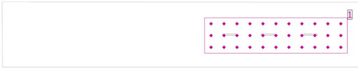
Altezza locale: 6.000 m, Coefficienti di riflessione: Soffitto 70.0%, Pareti 50.0%, Pavimento 20.0%, Fattore di diminuzione: 0.80
