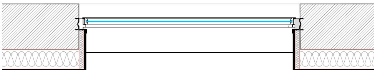
Figura 9 – Schema risolto cappotto esterno in pianta
