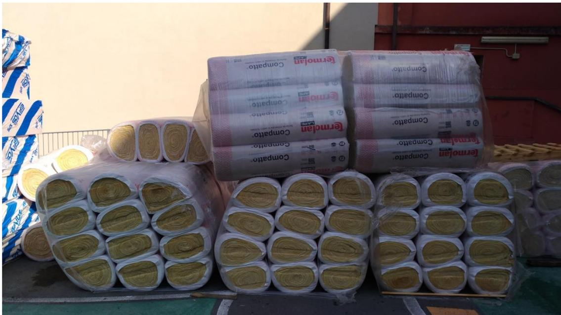
Figura 76. Rotoli di lana di vetro per l'isolamento del solaio
