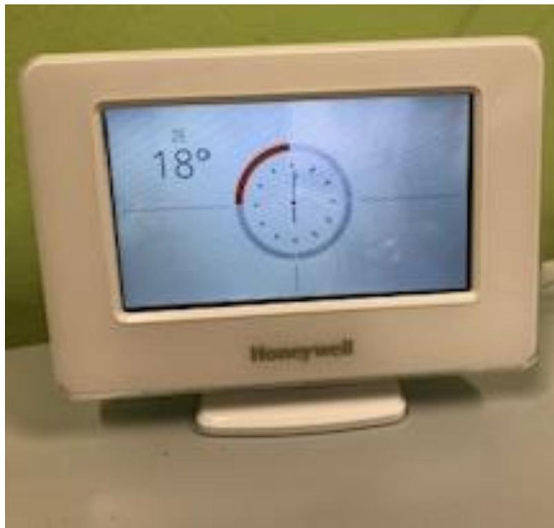
Figura 85. Cronotermostato ambiente collegato via wireless con valvole termostatiche digitali
