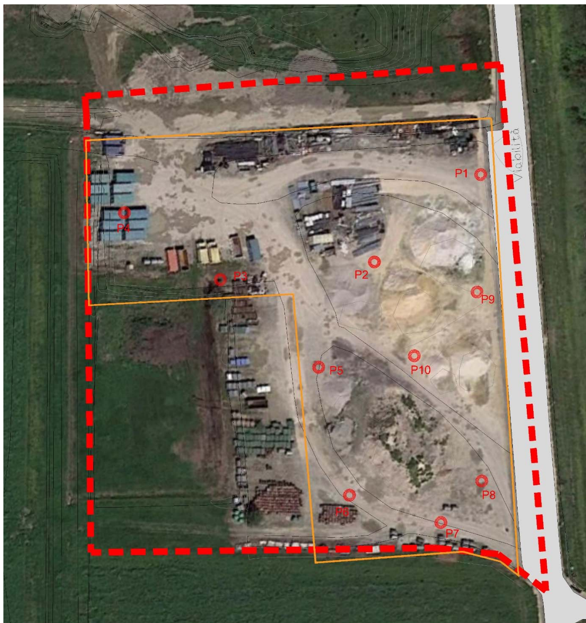
Figura 4 - Disposizione delle prove di piastra sull'area di intervento
