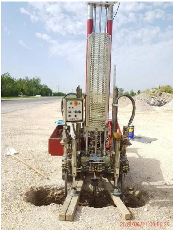
Punto esecuzione prova CPT01W (particolare scavo mat riporto)
