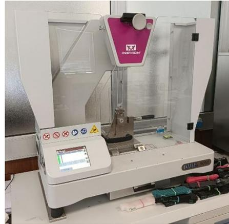
*Figura 71. Strumento per la prova di resistenza all'urto Izod o Charpy – laboratorio di Ecobat*
