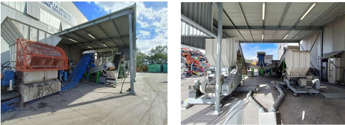
*Figura 36. Impianto di triturazione delle materie plastiche rigide*
