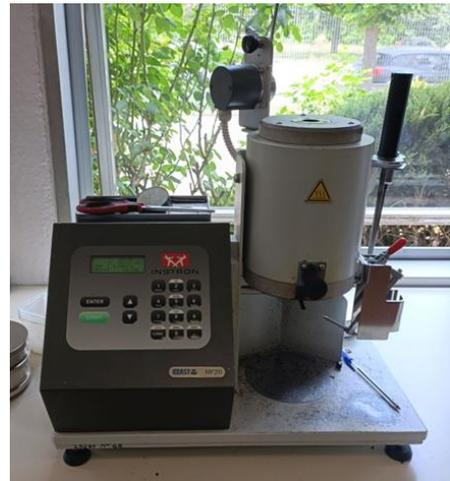
*Figura 69. Strumento di per la misura dell'indice di fluidità – laboratorio di Ecobat*
