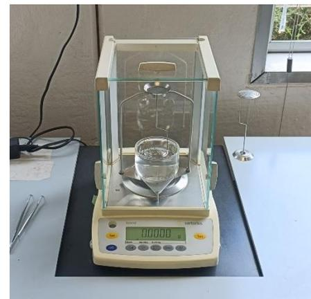
*Figura 70. Bilancia idrostatica per la misura della massa volumica – laboratorio di Ecobat*
