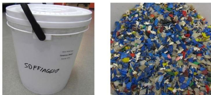
*Figura 76. Campione di HDPE da soffiaggio*
