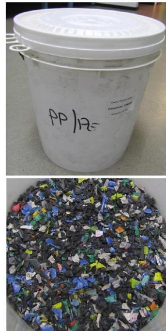
Figura 78. Campione di miscela PP-PE
