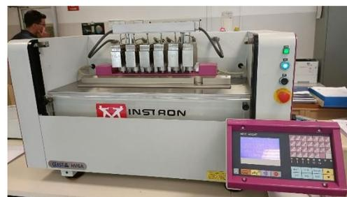
Figura 73. Strumento per la misura della temperatura di rammollimento Vicat – laboratorio di Ecobat
