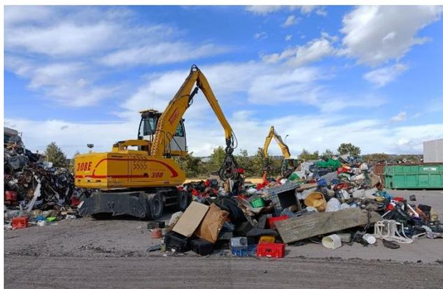
*Figura 30. La selezione delle plastiche rigide dai rifiuti ingombranti*
