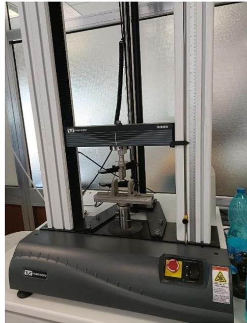
Figura 72. Strumento per le prove di flessione e trazione – laboratorio di Ecobat
