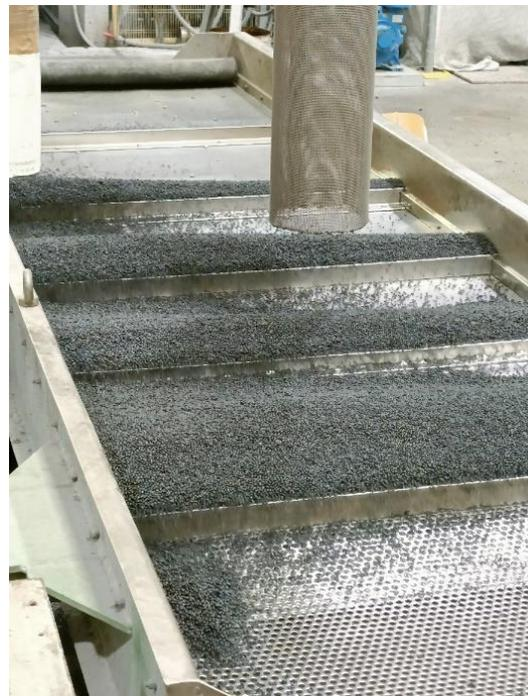
*Figura 68. I granuli in uscita dall'impianto di Ecobat*
