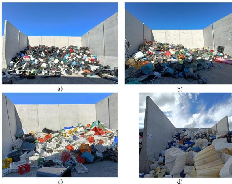
Figura 36. Baie di stoccaggio rifiuti da plastiche rigide: a) PP; b) PP-PE; c) HDPE da stampaggio; d) HDPE da soffiaggio
