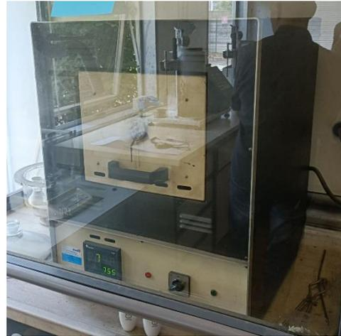
Figura 74. Strumento per il test delle ceneri – laboratorio di Ecobat
